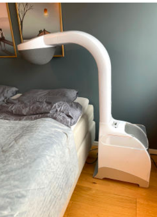
TLA-maskinen fjerner partikler som middstøv, katteallergener og pollen fra pustesonen.
